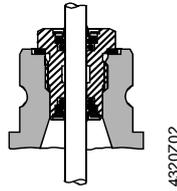
对于冷冻水、低温热水、高温热水、溴化锂（-25 ~ +130 度），EPDM O 型圈及铜卡环的密封圈的替代品为：
