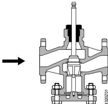
有导向的抛物线活塞，与阀杆连接在一起，阀座与阀体安装在一起.
